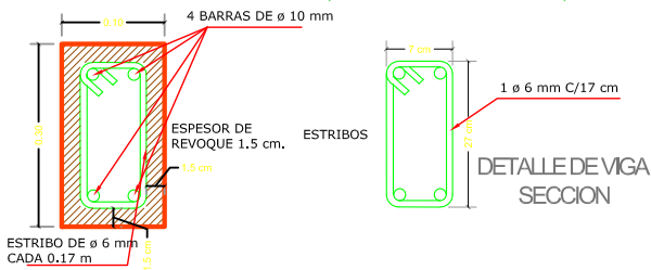
DETALLE DE VIGA 1
