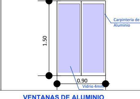
VENTANAS DE ALUMINIO LINEA 20 CON VIDRIO 4 mm
