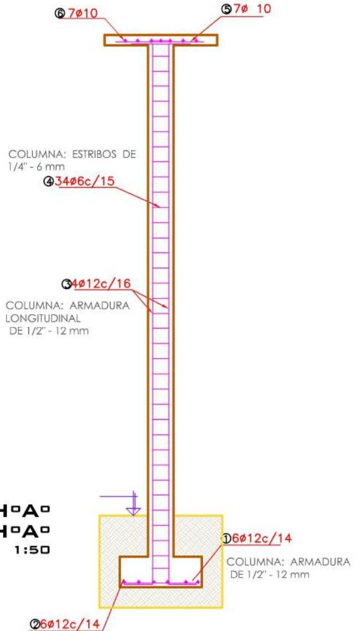
**DETALLE COLUMNA DE HºAº Y ZAPATA DE HºAº**
