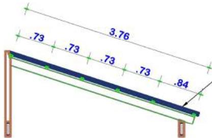
Cubierta de Calamina Galvanizada Ondulada
