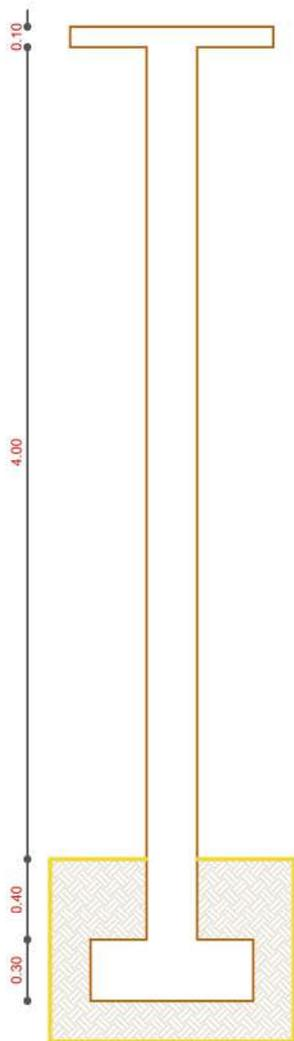
COLUMNA: ARMADURA LONGITUDINAL DE 1/2" 12 mm
