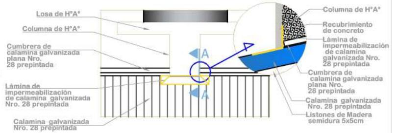
**DETALLE DE IMPERMEABILIZACIÓN DE CUBIERTA
