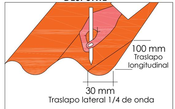
En el encuentro de cuatro placas se debe realizar el despunte / corte de esquinas para evitar la sobreposición de tejas y garantizar un óptimo funcionamiento a lo largo de la vida útil del material.
