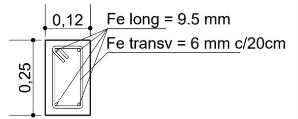
SECCIÓN DE VIGA CADENA DE H°A°
