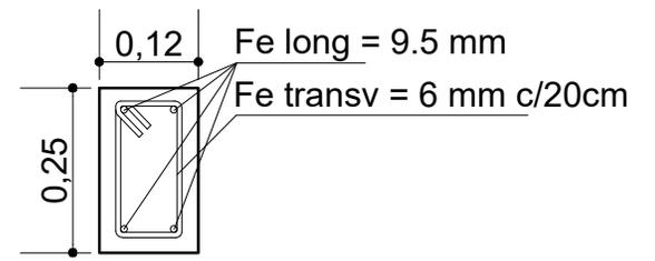
SECCIÓN DE VIGA CADENA DE H°A°
