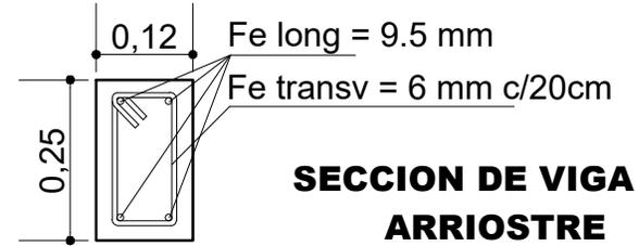
**SECCION DE VIGA DE ARRIOSTRE**
