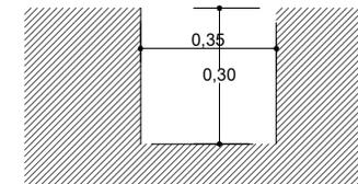
EXCAVACION DE CIMENTOS DE H<sup>o</sup>C<sup>o</sup>
