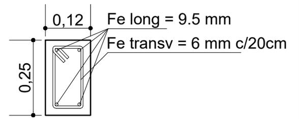
SECCIÓN DE VIGA CADENA DE H°A°
