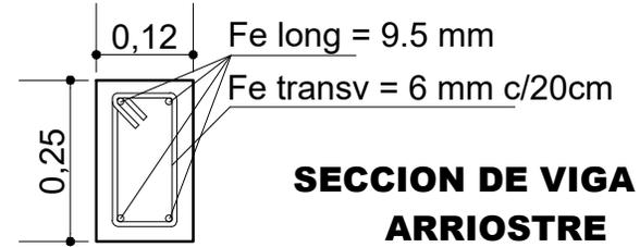
**SECCION DE VIGA DE ARRIOSTRE**
