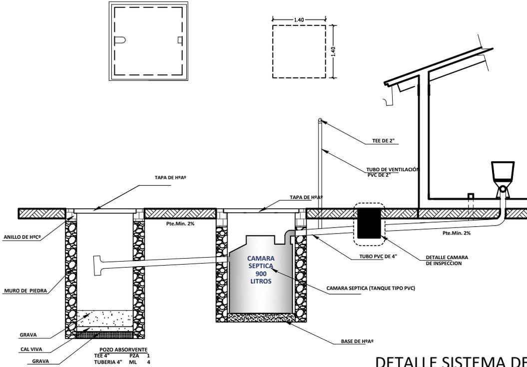
**DETALLE SISTEMA DE DESCARGA - CORTE**
