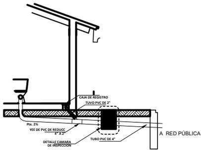
DETALLE SISTEMA DE DESCARGA - CORTE
