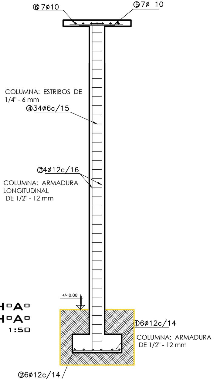
**DETALLE COLUMNA DE H<sup>0</sup>A<sup>0</sup> Y ZAPATA DE H<sup>0</sup>A<sup>0</sup>**
