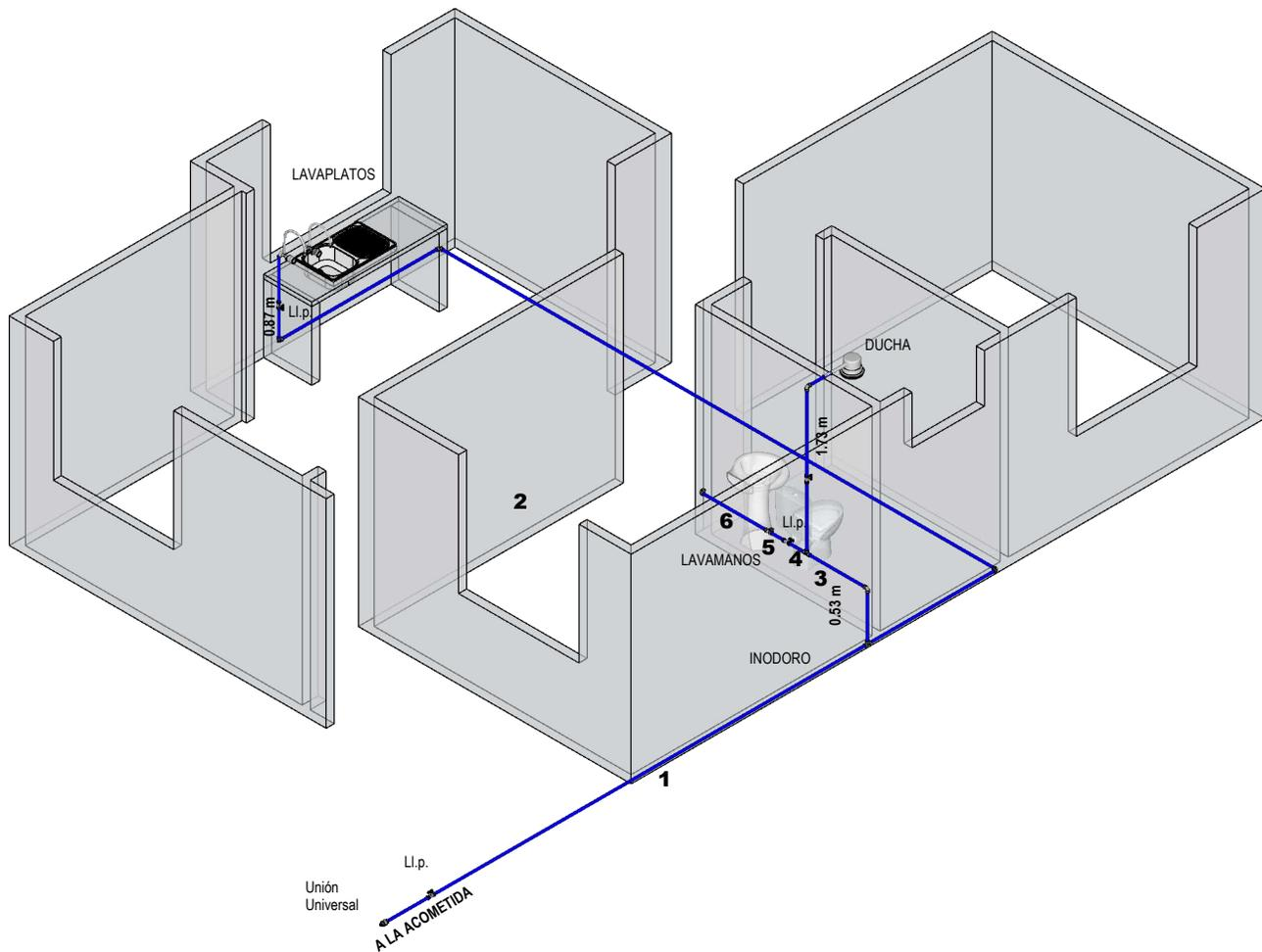
**INST. HIDRAULICA ISOMETRICO**
