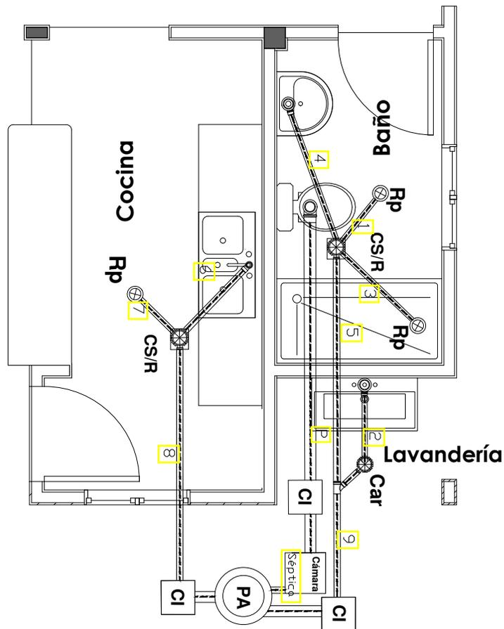
DETALLE SISTEMA DE DESCARGA - CORTE
