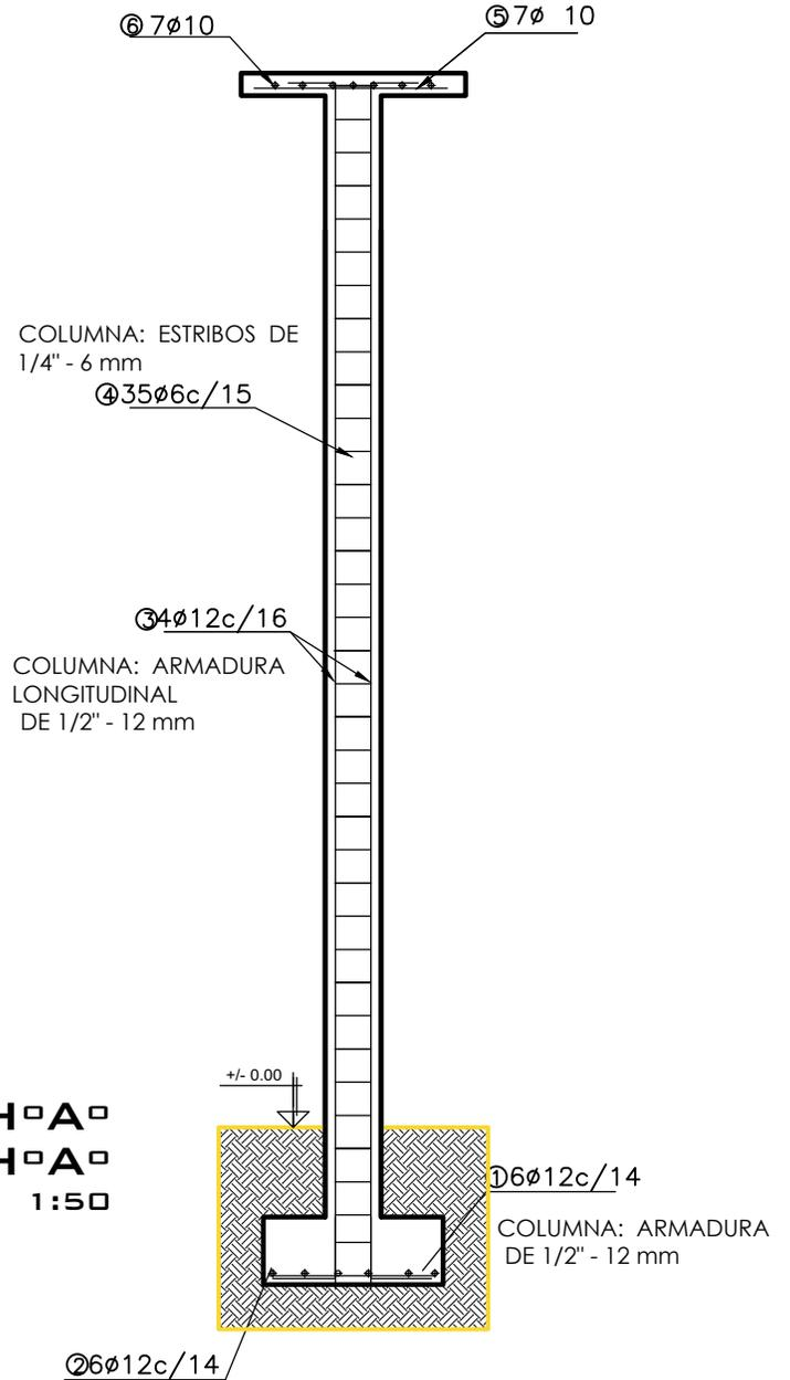
**DETALLE COLUMNA DE H<sup>o</sup>A<sup>o</sup> Y ZAPATA DE H<sup>o</sup>A<sup>o</sup>**
