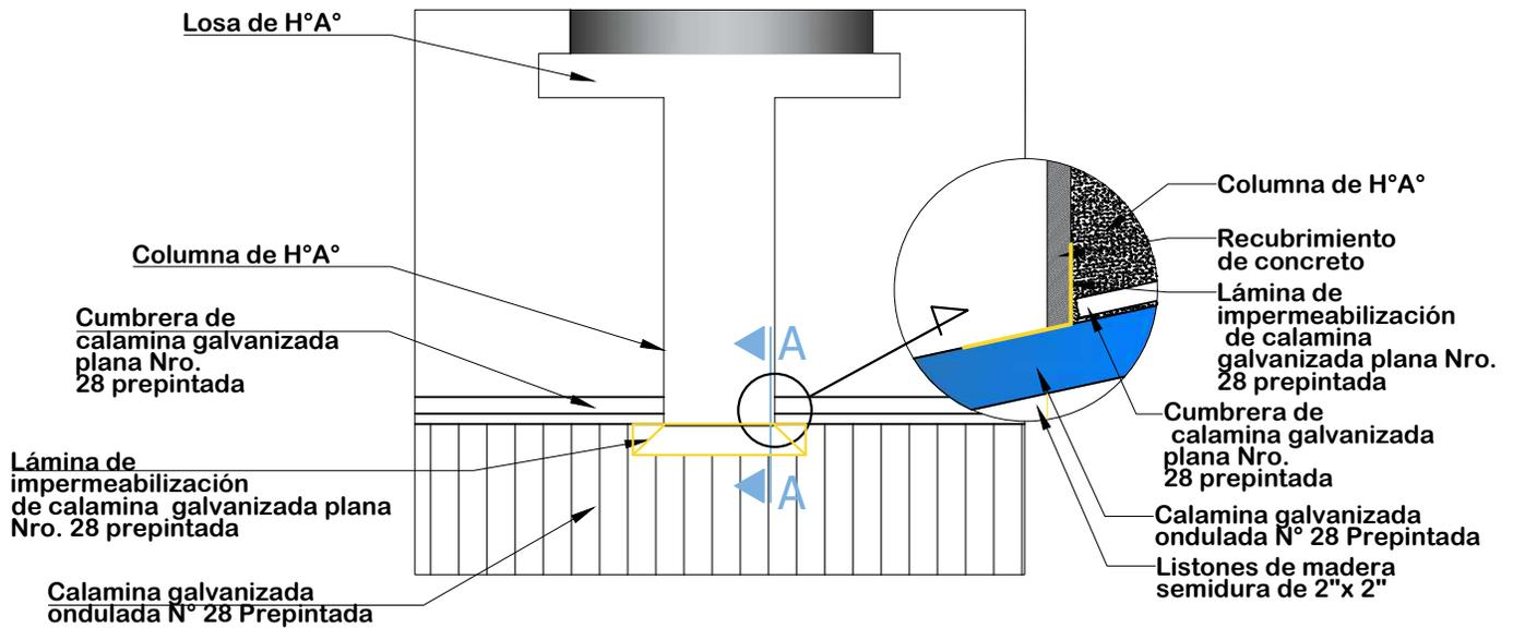
**DETALLE DE IMPERMEABILIZACIÓN DE CUBIERTA**
