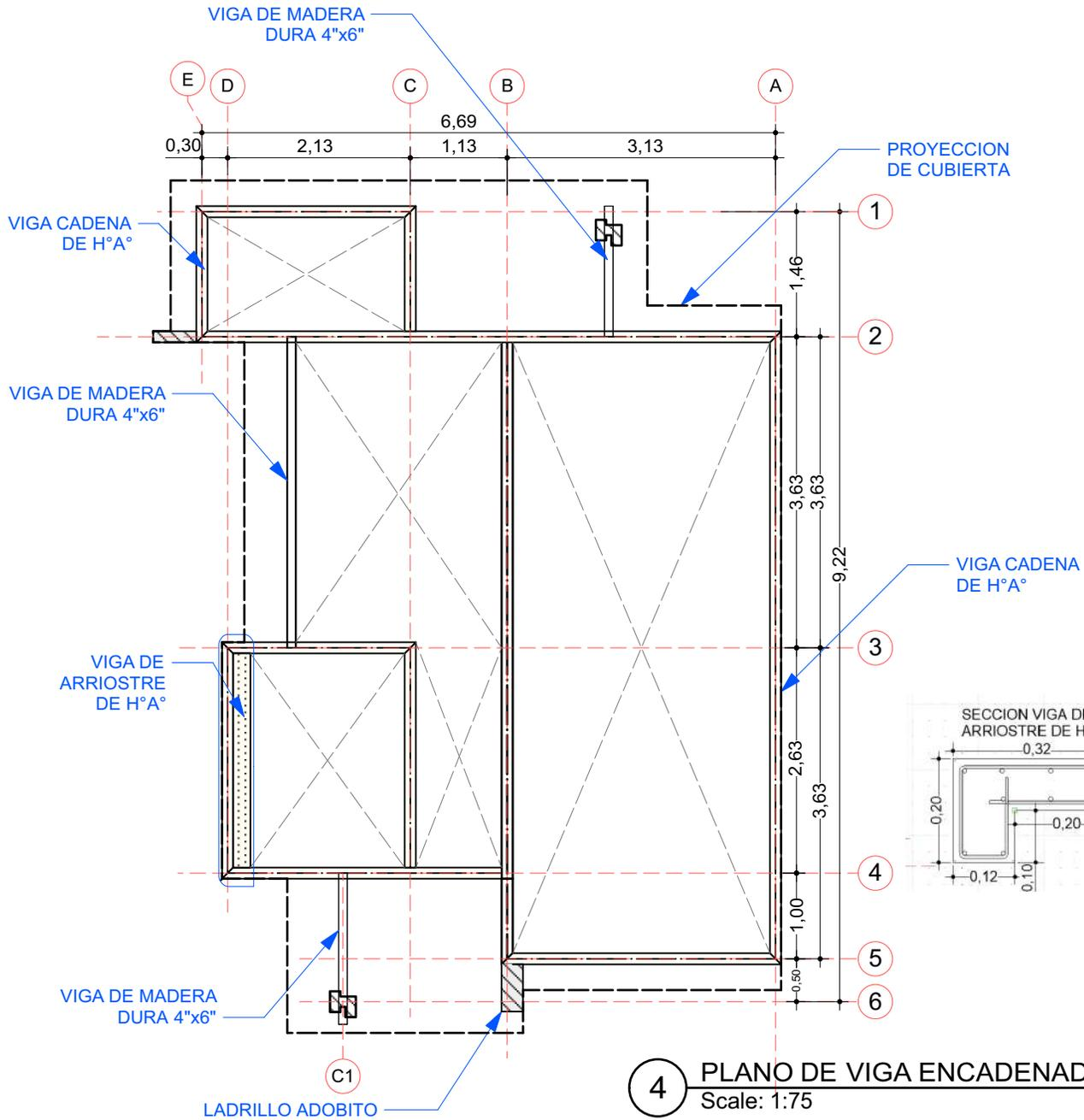
4 PLANO DE VIGA ENCADENADO
