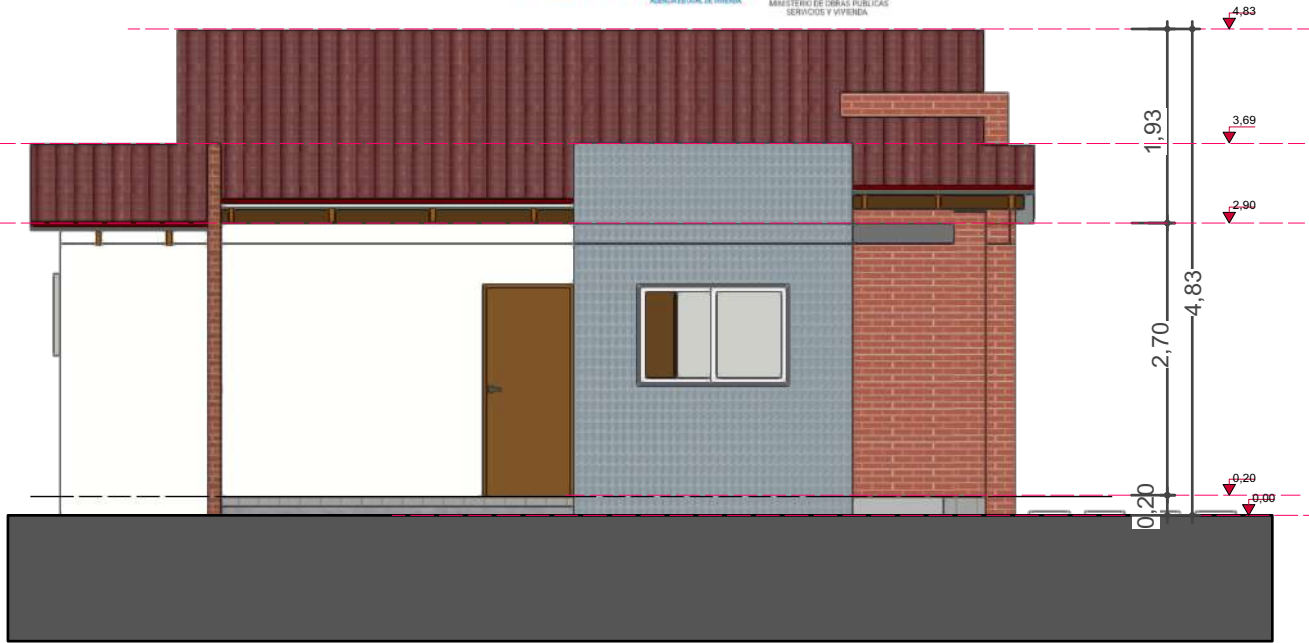
12 FACHADA LATERAL IZQUIERDA Scale: 1:75
