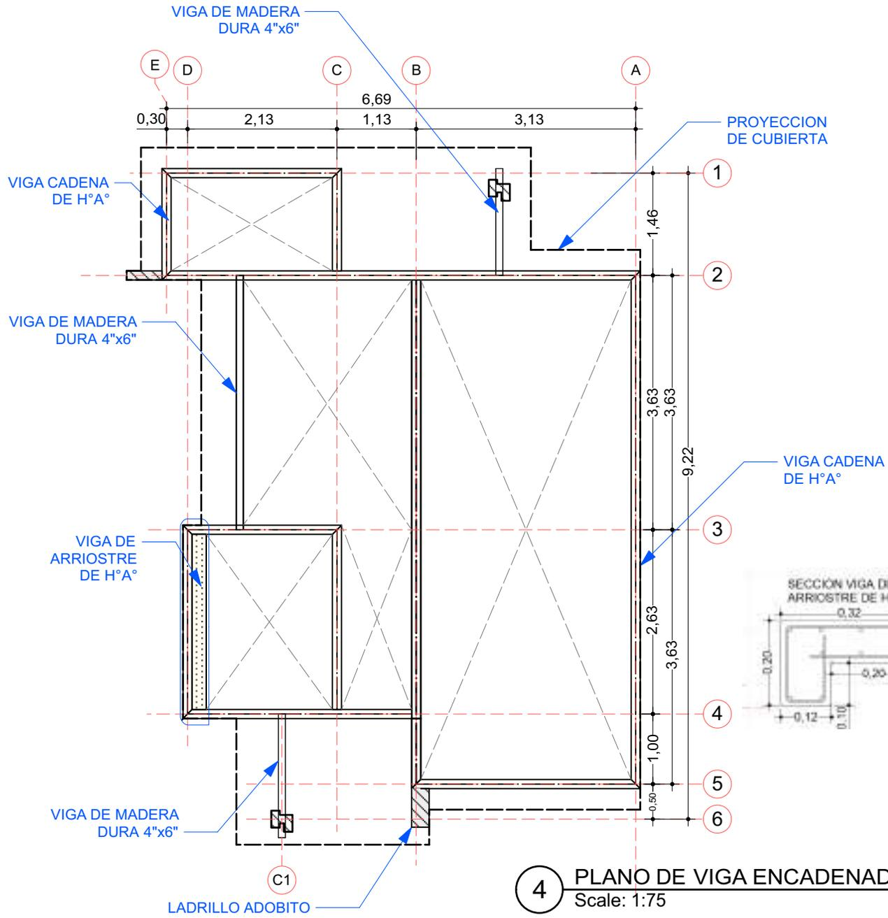
**4 PLANO DE VIGA ENCADENADO**
