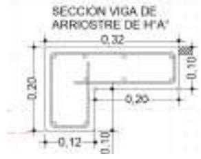
**SECCION VIGA CADENA DE H°A°**
