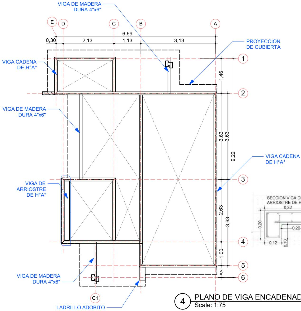
4 PLANO DE VIGA ENCADENADO
