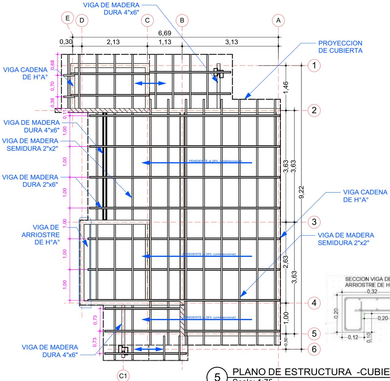
5 PLANO DE ESTRUCTURA -CUBIERTA
