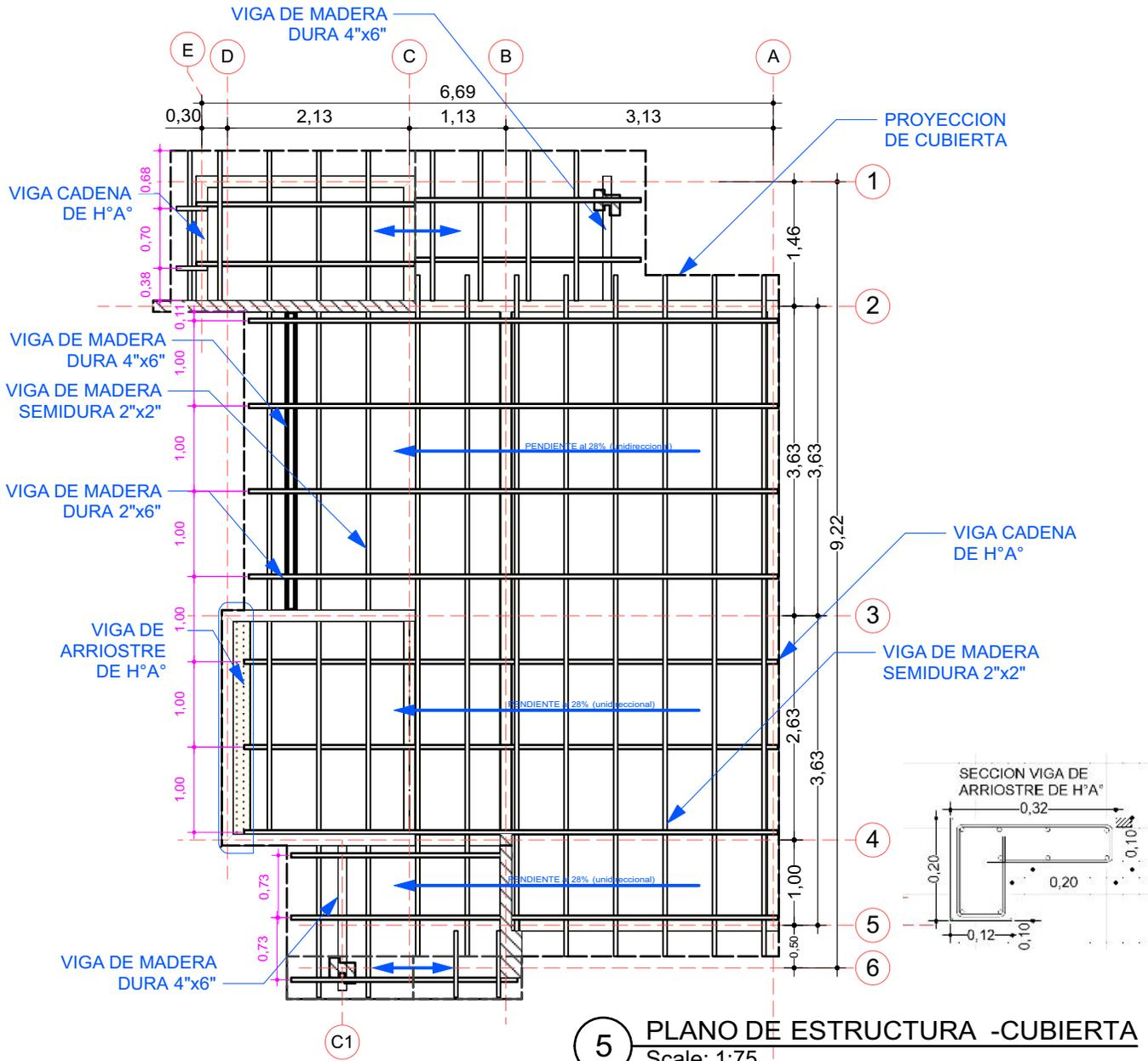
**5 PLANO DE ESTRUCTURA -CUBIERTA**
