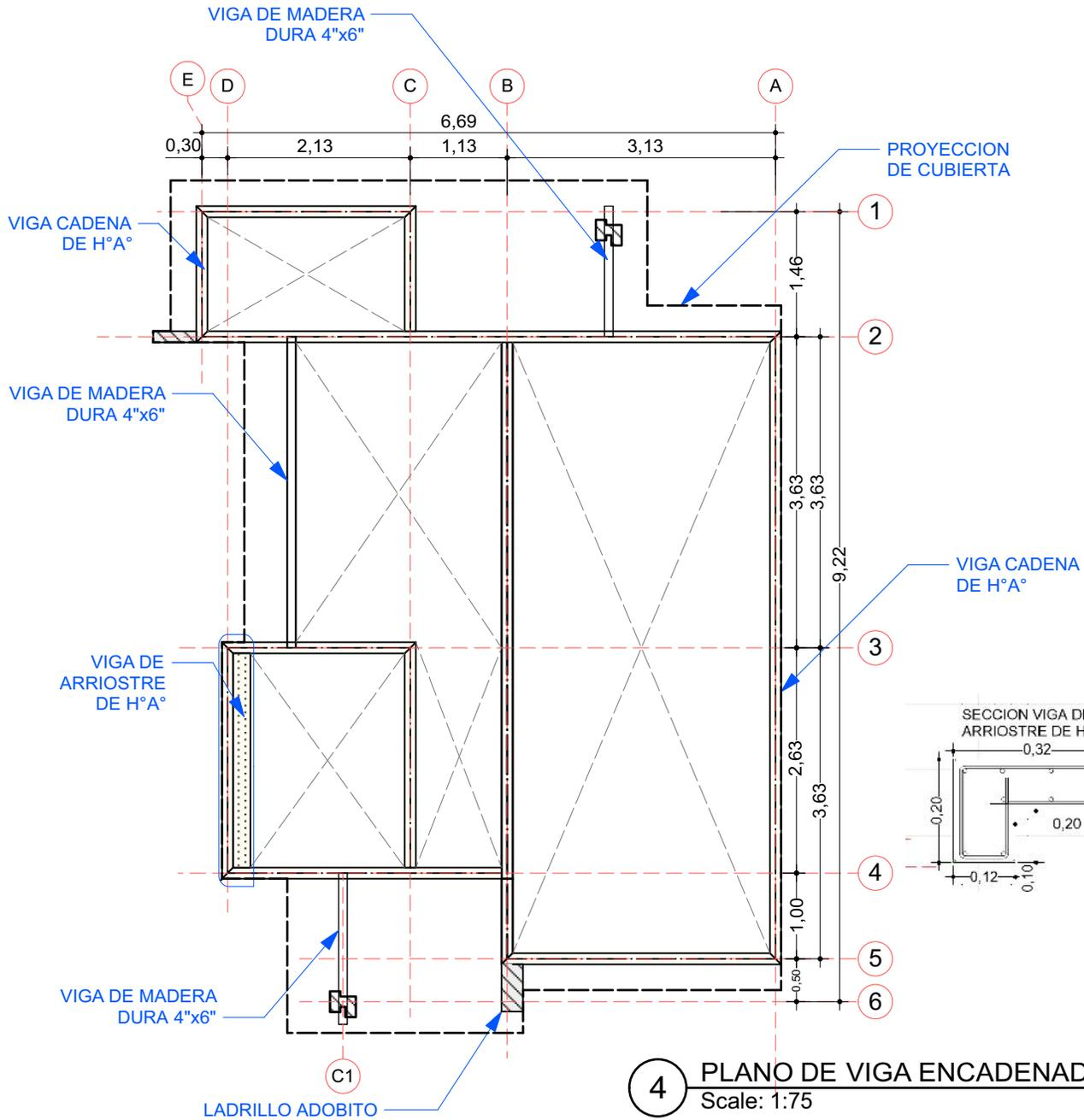
4 PLANO DE VIGA ENCADENADO
