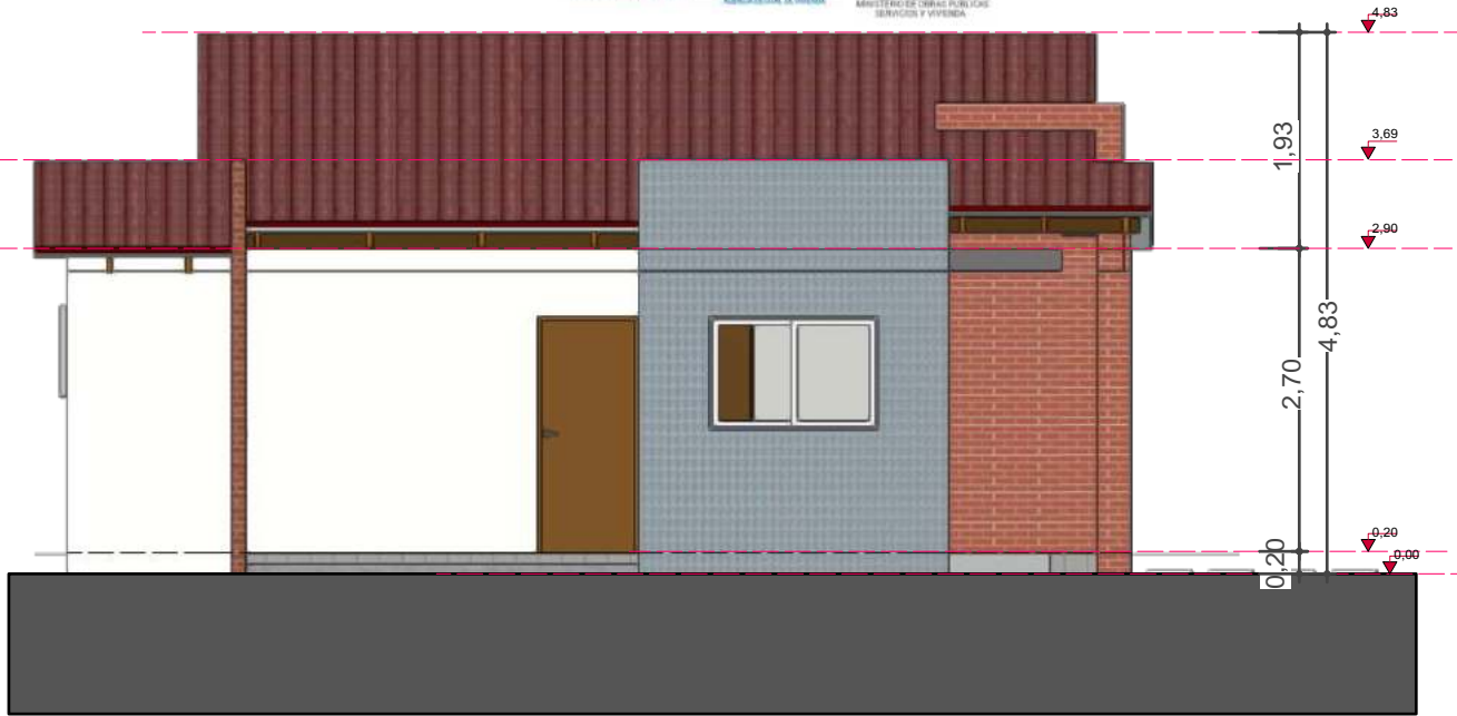
12 FACHADA LATERAL IZQUIERDA Scale: 1:75
