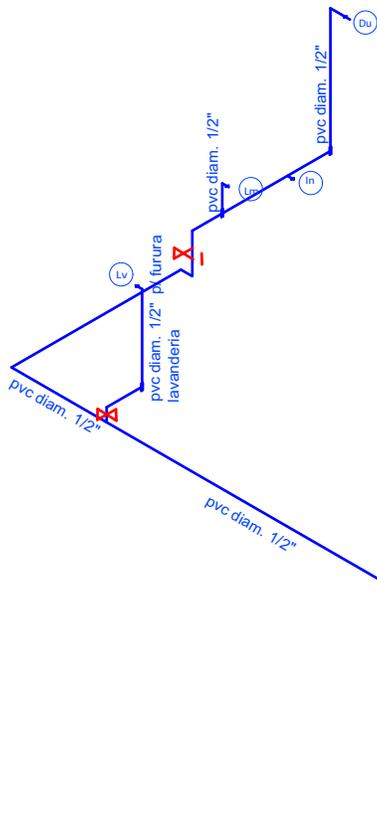
40 PLANO ESQUEMATICO ISOMETRICO - DE INSTALACION HIDRAULICA
