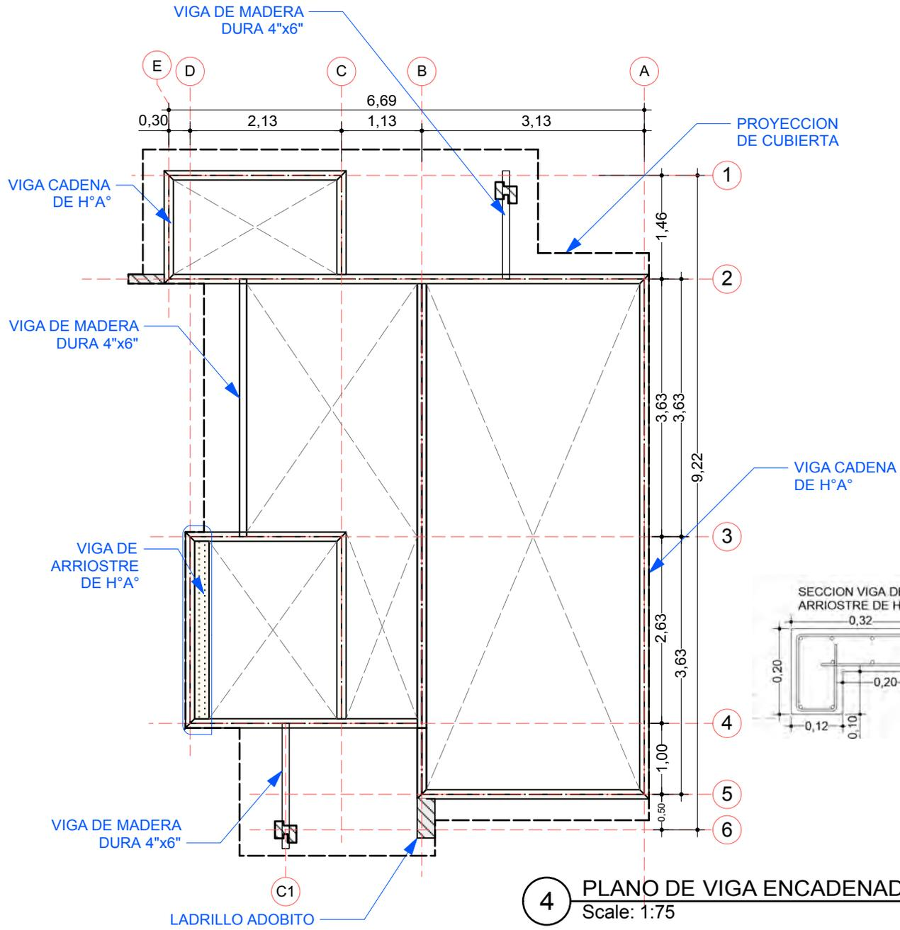
4 PLANO DE VIGA ENCADENADO
