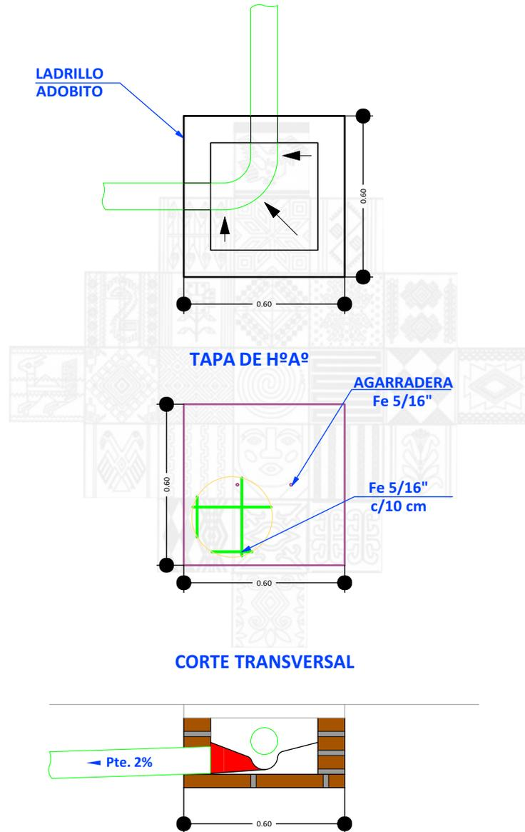
17 **DETALLE CONST. - CAMARA DE INSPECCION (0,60x0,60)**
