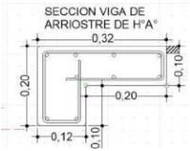
4 PLANO DE VIGA DE ENCADENADO
