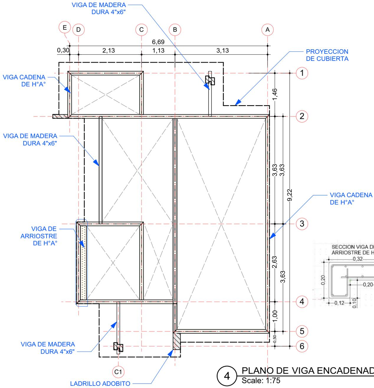
4 PLANO DE VIGA ENCADENADO
