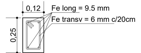
SECCIÓN DE VIGA CADENA DE H°A°
