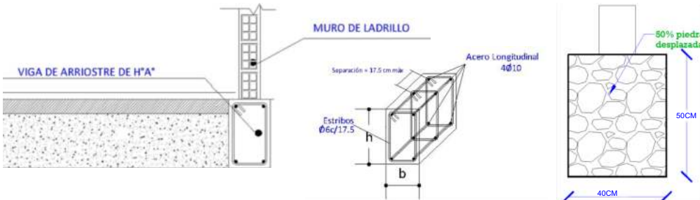
VIGA DE ARRIOSTRE DE HORMIGON ARMADO DE 0,15X0,20 M
