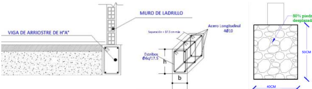
BASE DE HORMIGON CICLOPEO PARA COLUMNA
