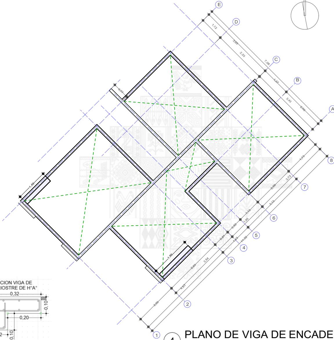
4 PLANO DE VIGA DE ENCADENADO
