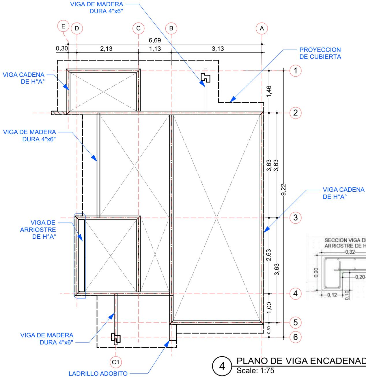
4 PLANO DE VIGA ENCADENADO
