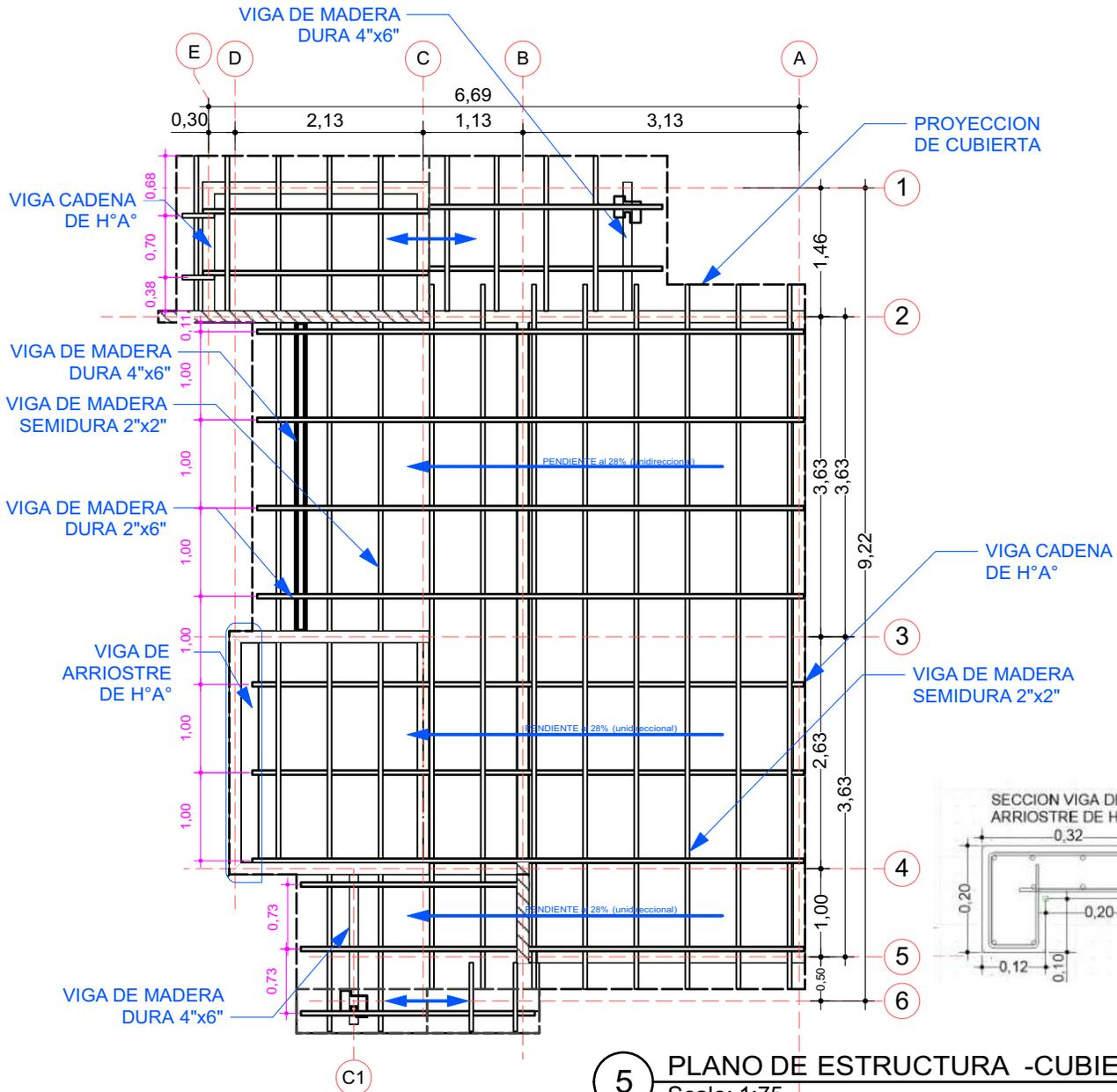
5 PLANO DE ESTRUCTURA -CUBIERTA
