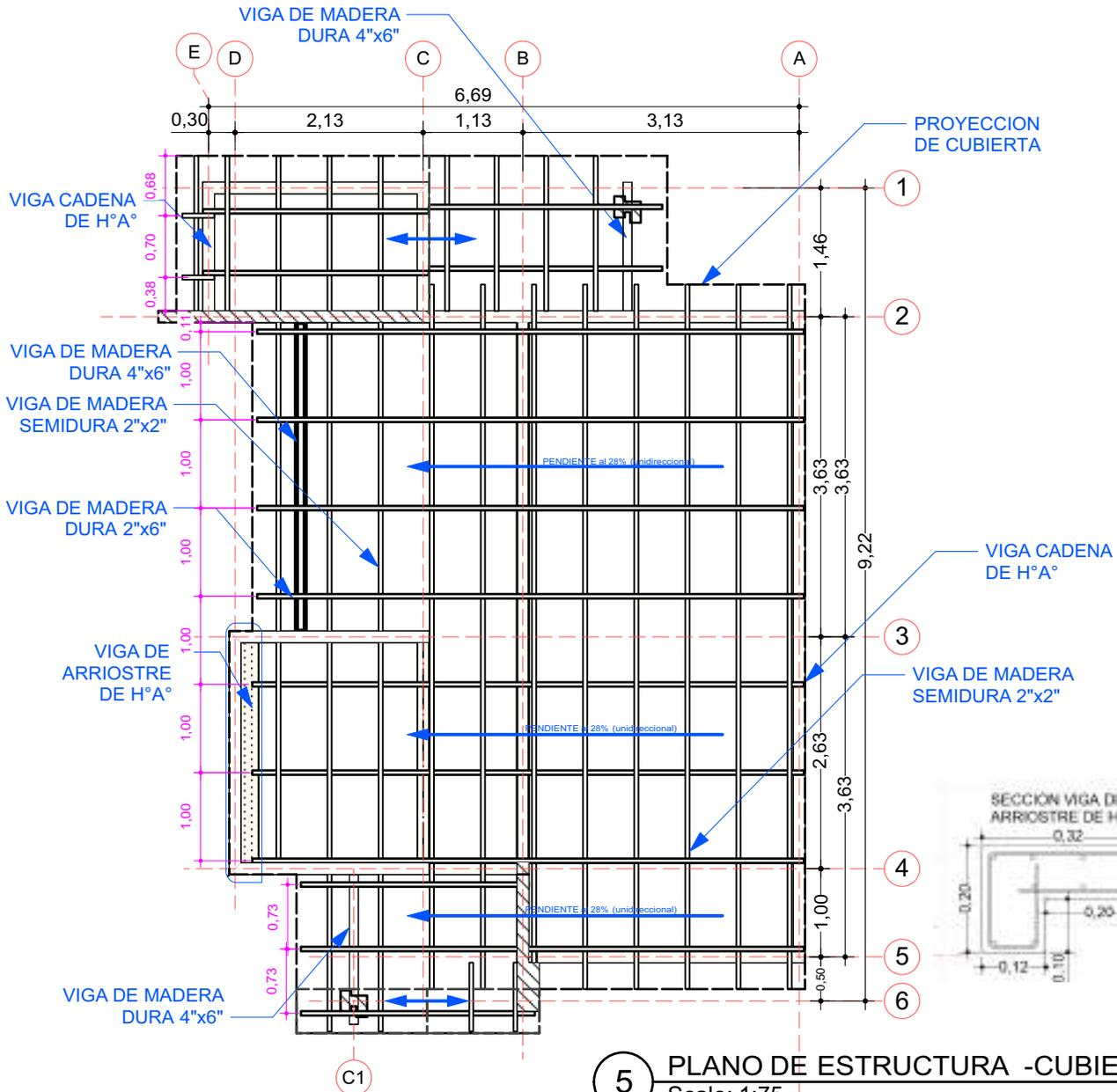
**5** PLANO DE ESTRUCTURA -CUBIERTA
