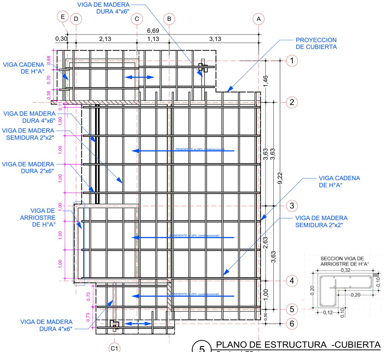
5 PLANO DE ESTRUCTURA -CUBIERTA
