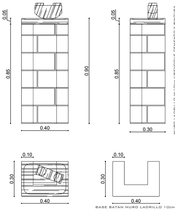
MURO LADRILLO H: 10CM C/REVOQUE CEMENTO Y PINTURA
