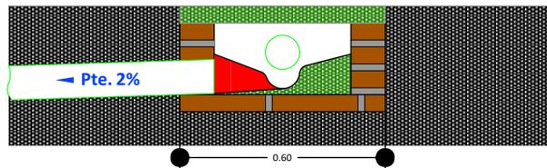
17 **DETALLE CONST. - CAMARA DE INSPECCION (0,60x0,60)**
