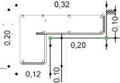
SECCION VIGA CADENA DE H°A°
