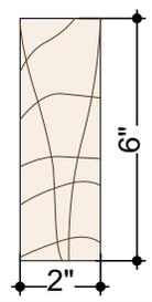
SECCION DE LISTON DE MADERA SEMIDURA 2"x2"
