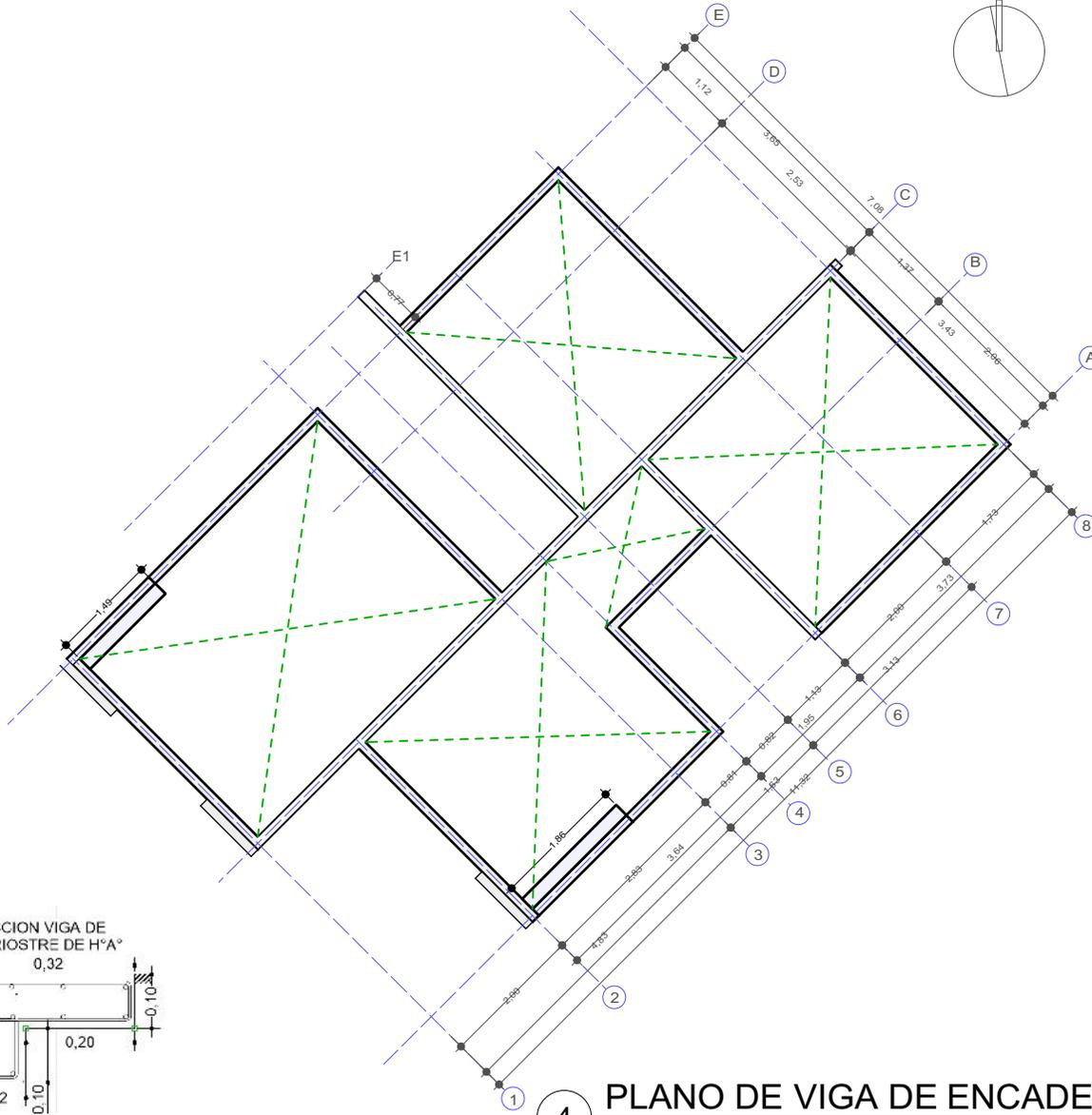
4 PLANO DE VIGA DE ENCADENADO
