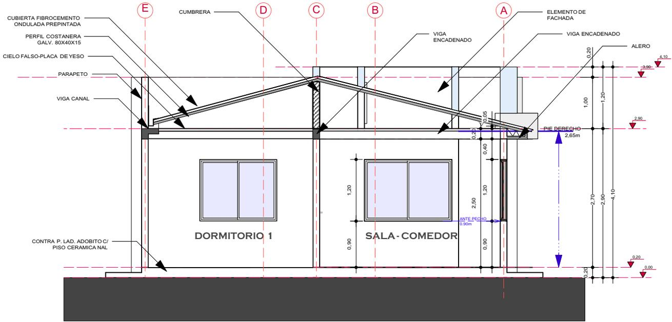
8 CORTE DE SECCION A-A'
