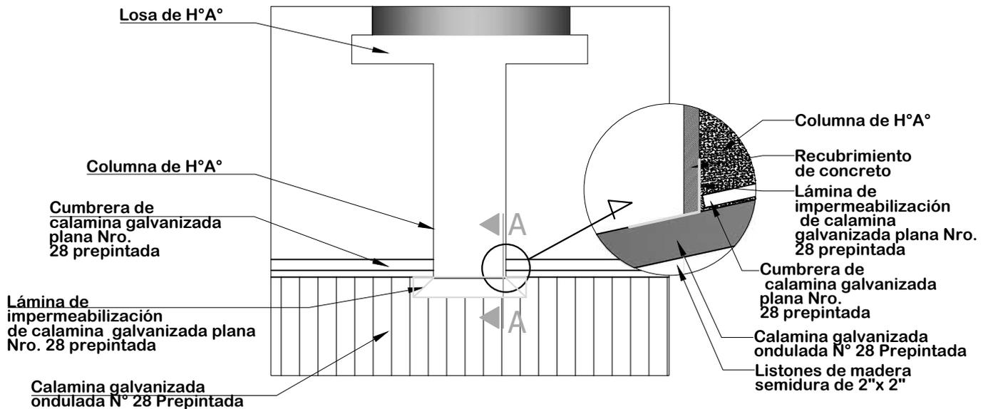
**DETALLE DE IMPERMEABILIZACIÓN DE CUBIERTA**
