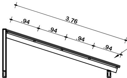
Cubierta de Calamina Galvanizada Ondulada
