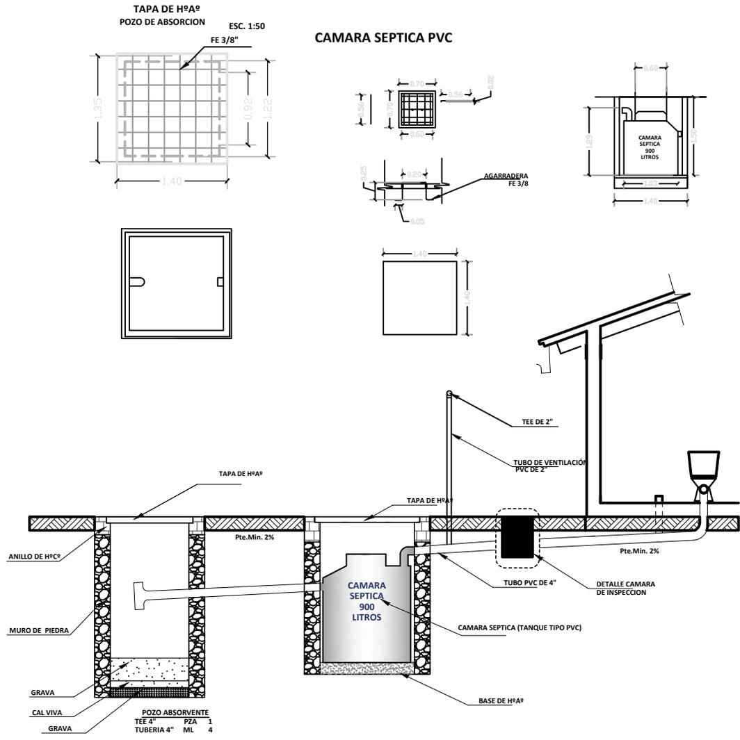
**DETALLE SISTEMA DE DESCARGA - CORTE**
