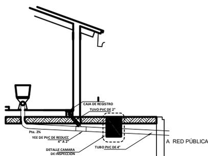
DETALLE SISTEMA DE DESCARGA - CORTE
