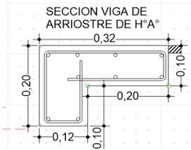
SECCION VIGA CADENA DE H'A°
