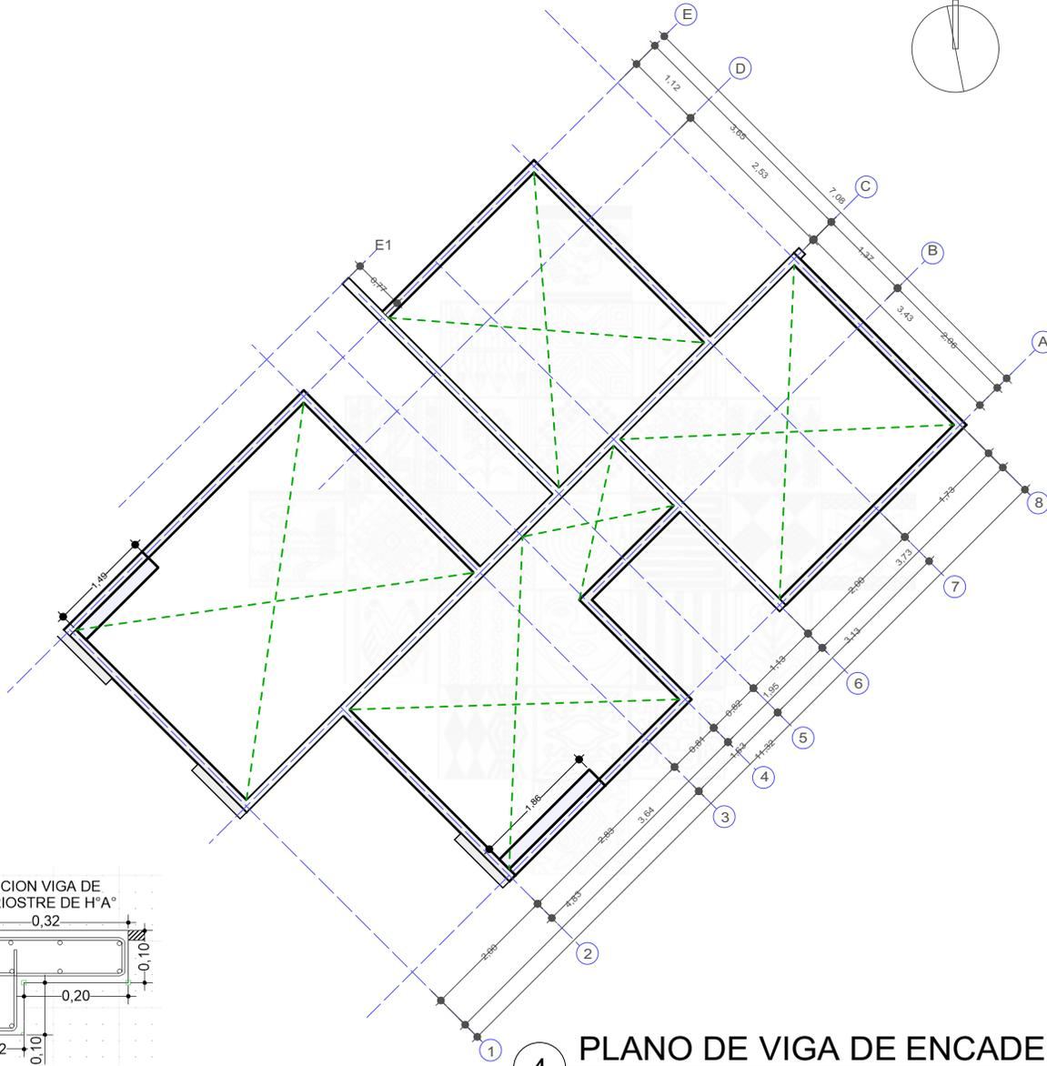
4 PLANO DE VIGA DE ENCADENADO
