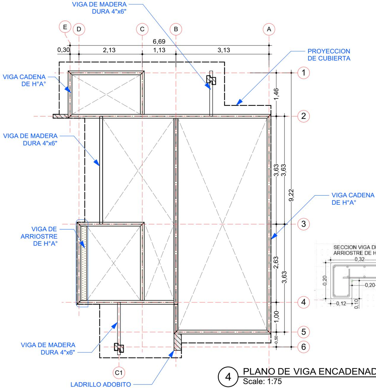
4 PLANO DE VIGA ENCADENADO
