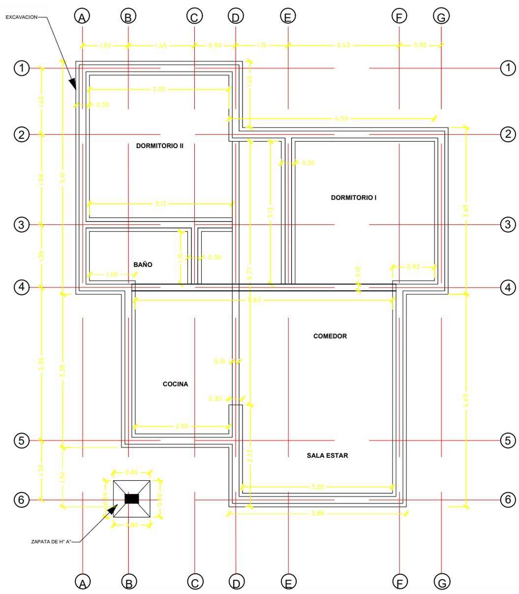
**PLANO DE EXCAVACION ESC.: 1:75**
