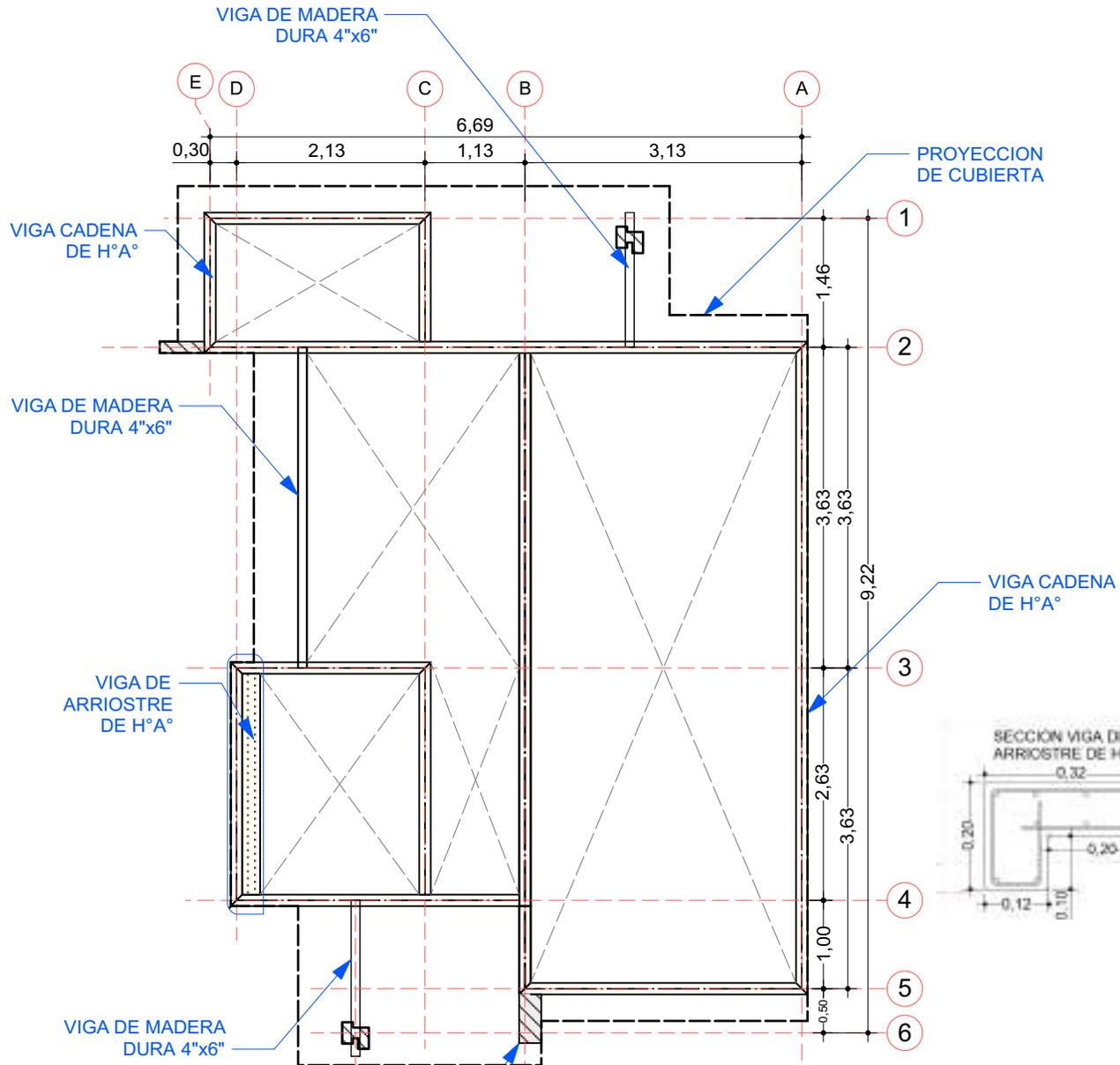
4 PLANO DE VIGA ENCADENADO
