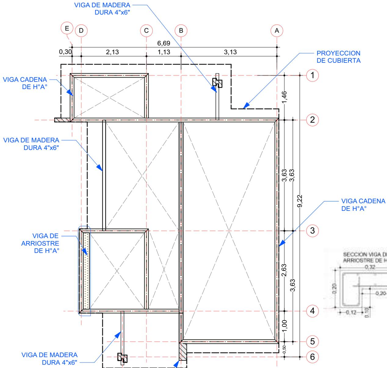
4 PLANO DE VIGA ENCADENADO
