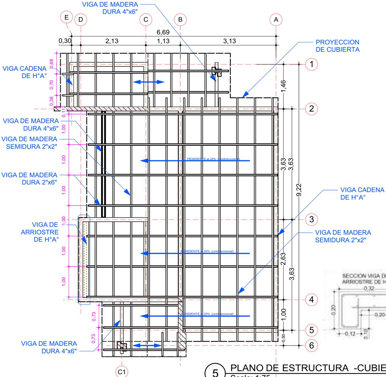
**5** PLANO DE ESTRUCTURA -CUBIERTA
