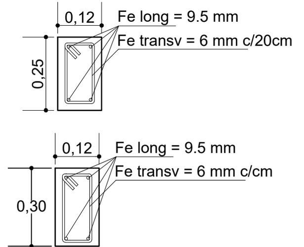
SECCIÓN DE VIGA CADENA DE H°A°
