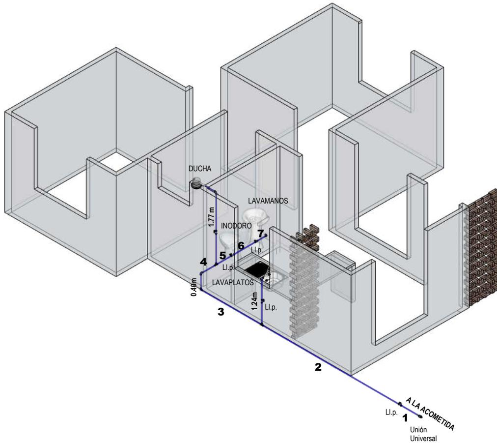
**INST. HIDRAULICA ISOMETRICO**
