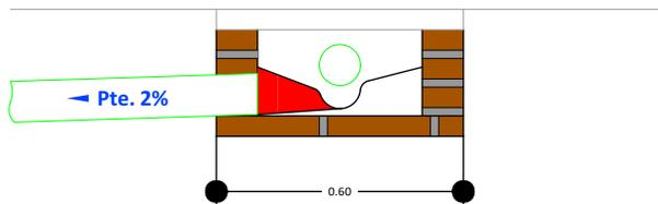
17 **DETALLE CONST. - CAMARA DE INSPECCION (0,60x0,60)**
