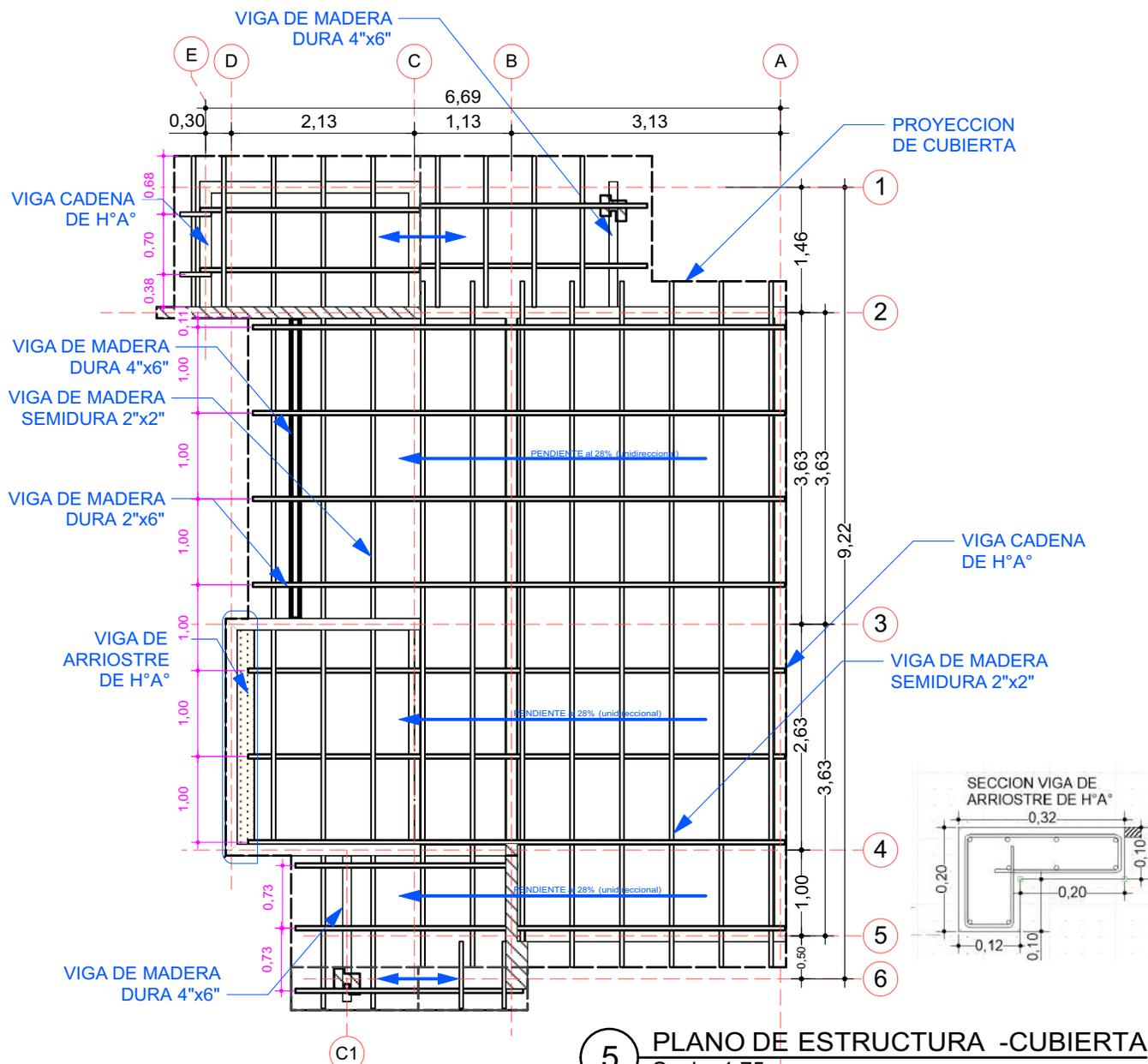
5 PLANO DE ESTRUCTURA -CUBIERTA
