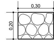
**SECCIÓN DE COLUMNA SIN VINCULACIÓN EXTERIOR DE H°A°**
