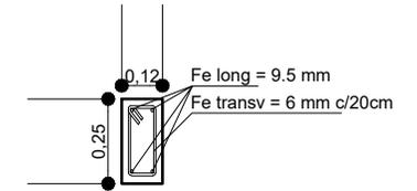
**SECCION DE VIGA CADENA DE H°A°**
