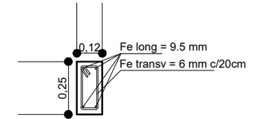
**SECCION DE VIGA CADENA DE H°A°**
